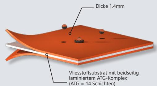
Der ML31-Komplex ist ein Komplex aus zwei ATGSchutzmembranen, die mit einem Vliesstoff geschichtet sind.
