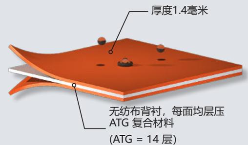
ML31 复合材料是两层 ATG 阻隔膜层压到无纺布背衬上的复合材料。
