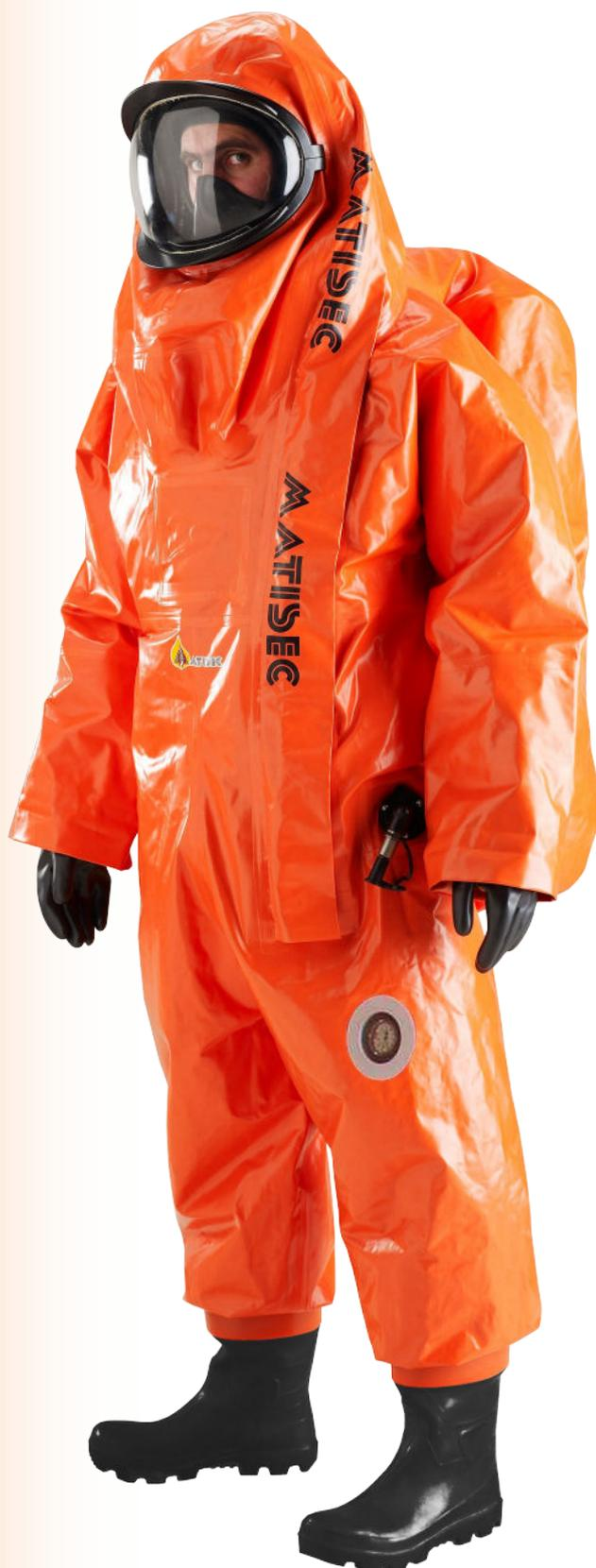
Le scaphandre «GR IV SOL» est un vêtement de protection réutilisable contre les produits chimiques liquides et gazeux, y compris les aérosols liquides et les particules solides, non ventilé et de type 1a-ET (étanche au gaz selon norme EN 943-2).
