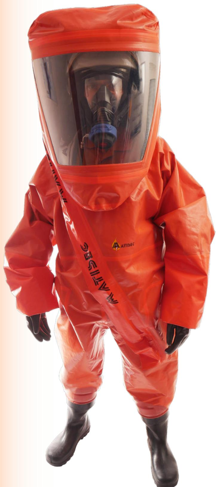
La escafandra «DM II» es un traje de protección reutilizable contra productos químicos líquidos y gaseosos, incluidos aerosoles líquidos y partículas sólidas, no ventilado y de tipo 1a-ET (hermético a los gases según la norma EN 943-2).
