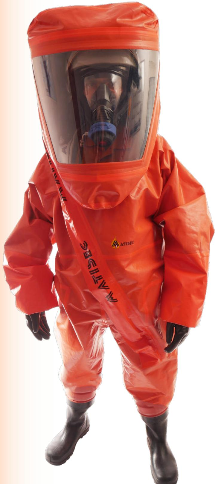
DM II 化学防护服是一种可重复使用的防护服，分为非通风型和1a-ET类型（根据EN 943-2标准定义的气密性），其针对包括液体气溶胶和固体颗粒在内的液态和气态化学品。它保证针对众多活动领域（化学或石油工业、救援队、废物管理等）中使用的大量危险的液体或气体化学物质提供全面防护。此防护服与内部携带的开放式正压绝缘呼吸器结合使用。
